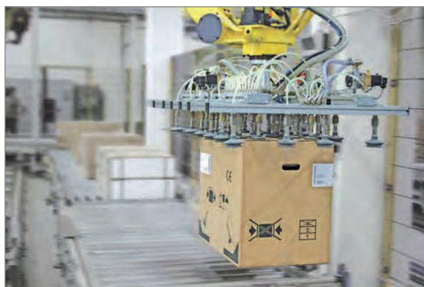
天然橡胶制作的柔软TGAS-NK吸盘用于搬运纸箱
